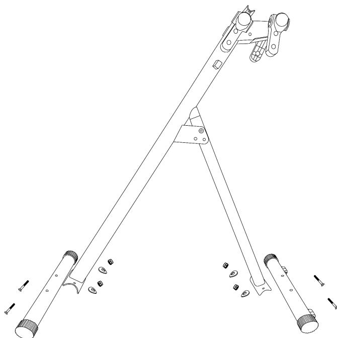
Lösen Sie die Schrauben 8\*60 (16), Unterlegscheiben (17) und Muttern (18) von der vorderen Stütze (3) und der hinteren Stütze (2). Befestigen Sie dann die vorderen Stütze (3) und die hinteren Stütze (2) mit Hilfe des Schraubenschlüssels (19) am Hauptrahmen (1).
