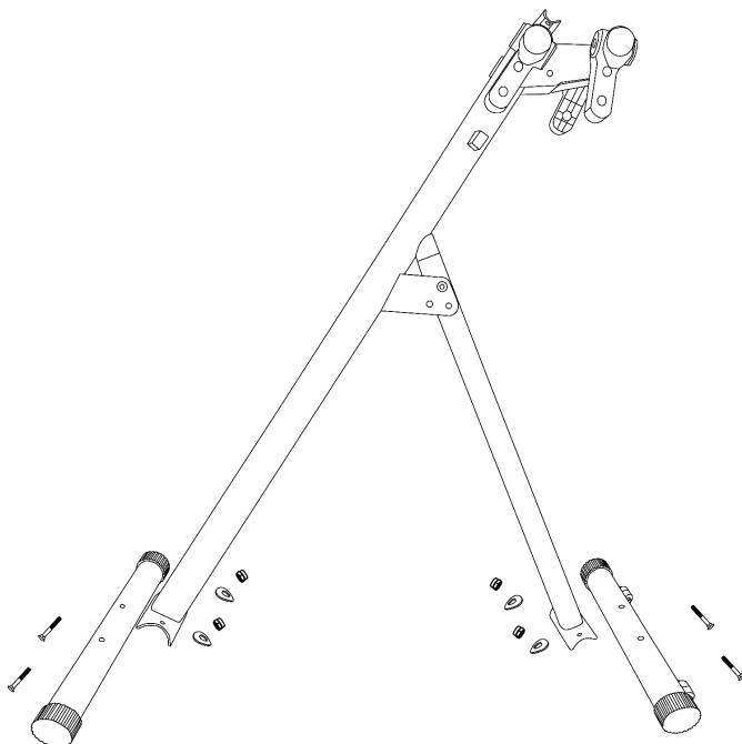
Afloje los tornillos 8\*60 (16), arandelas (17) y tuercas (18) del soporte delantero (3) y del soporte trasero (2). A continuación, fije el soporte delantero (3) y el trasero (2) al cuadro principal (1) con la llave (19).
