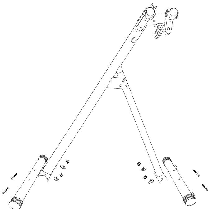
Svitare le viti 8x60 (16), le rondelle (17) e i dadi (18) dal sostegno anteriore (3) e posteriore (2). Fissare poi il sostegno anteriore (3) e posteriore (2) al telaio principale (1) utilizzando la chiave inglese (19).
