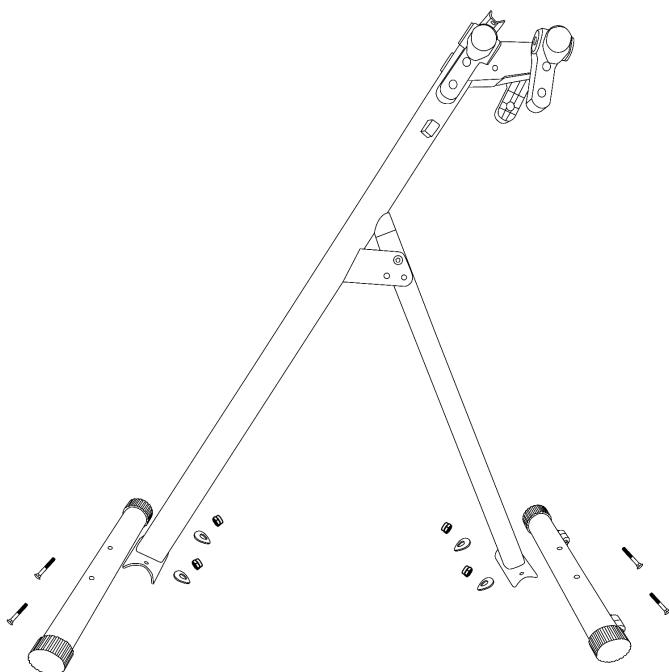
Desserrez les vis 8 \* 60 (16), les rondelles (17) et les écrous (18) du support avant (3) et du support arrière (2). Attachez ensuite le Support Avant (3) et le Support Arrière (2) au Cadre Principal (1) à l'aide de la Clé (19).
