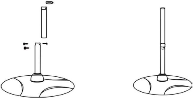
Befestigen Sie das untere Rohr mit drei 5\*6 mm Schrauben am weiten Rohr und setzen Sie die erste Kabelhalterung auf das Mittelrohr.
