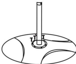
Befestigen Sie das untere Rohr mit vier 6\*35 mm Schrauben am Ständer.
