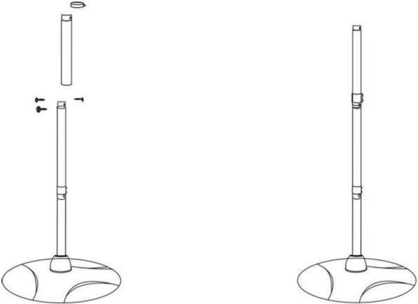
Befestigen Sie das dritte Rohr auf die gleiche Art, wie in Schritt 3 beschrieben, und setzen Sie die zweite Kabelhalterung auf das dritte Rohr.
