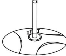
Fixez le tube inférieur au support avec quatre vis de 6 \* 35 mm.
