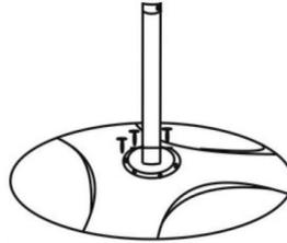
Fije el conducto inferior con cuatro tornillos 6x35 mm al soporte.
