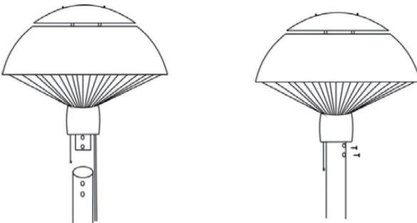
Fixez la tête de chauffage au tube supérieur à l'aide de deux vis 4 \* 12mm.
