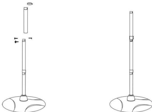
Fije el tercer conducto del mismo modo que se describe en el paso 3 y coloque el segundo soporte del cable en el tercer conducto.
