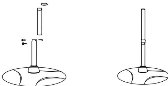
Fije el conducto inferior con tres tornillos 5x6 mm al conducto ancho y coloque el primer soporte del cable en el conducto intermedio.
