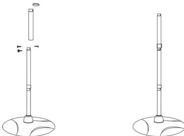
Fissare il terzo tubo come descritto nella fase 3 e mettere il secondo portacavo sul terzo tubo.
