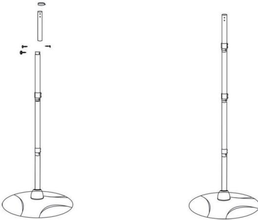
Befestigen Sie das vierte Rohr auf die gleiche Art, wie in Schritt 3 beschrieben, und setzen Sie die dritte Kabelhalterung auf das vierte Rohr.
