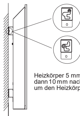
Den Heizkörper von der Wand nehmen
