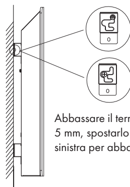
Rimuovere il termoconvettore dalla parete
