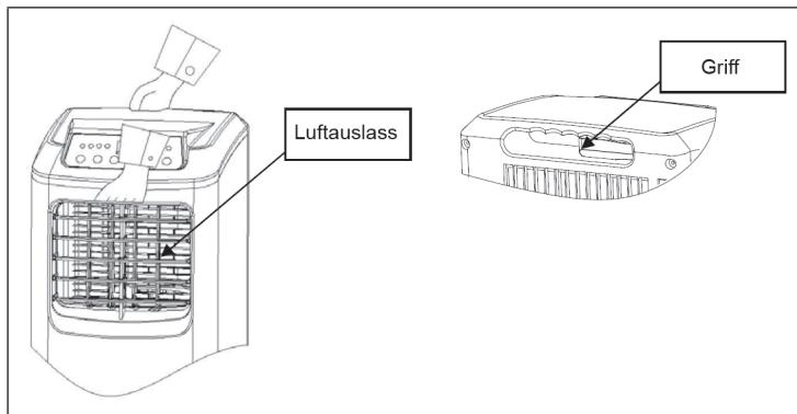
**Hinweis:** Halten Sie das Gerät nicht an einem der horizontalen Lüftungsschlitz und kippen Sie es beim Transport nicht. Falls sich die Fernbedienung im Einschub befindet, entfernen Sie diese, bevor Sie das Gerät anheben.
