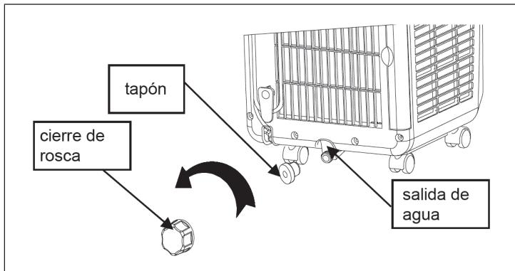
**Nota:** tenga cuidado de no extraviar el tapón o el cierre de rosca. En caso de que el recipiente esté lleno antes de que el depósito haya sido vaciado, coloque a tiempo el tapón en la válvula para que el agua no se salga del recipiente y moje el suelo.
