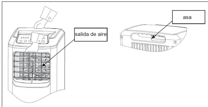
**Hinweis:** Halten Sie das Gerät nicht an einem der horizontalen Lüftungsschlitz und kippen Sie es beim Transport nicht. Falls sich die Fernbedienung im Einschub befindet, entfernen Sie sie, bevor Sie das Gerät anheben.
