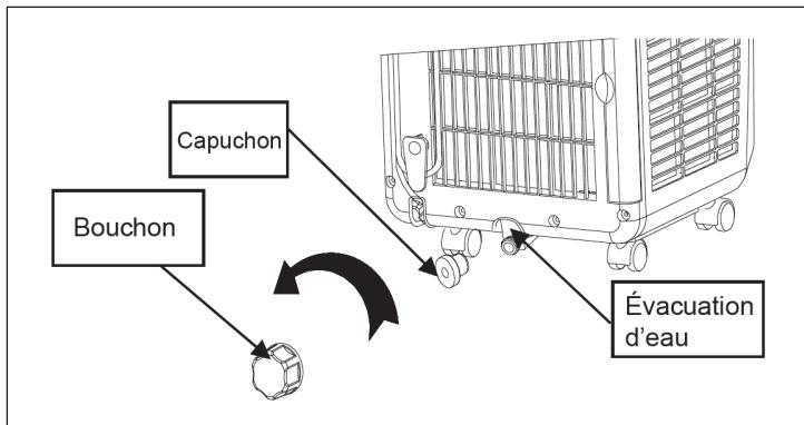
**Note :** veiller à ne pas perdre le capuchon et le bouchon. Si le récipient est plein et qu'il reste de l'eau dans le réservoir, replacer correctement le capuchon dans la valve de manière à ce que l'eau ne s'échappe pas et ne s'écoule pas sur le sol.
