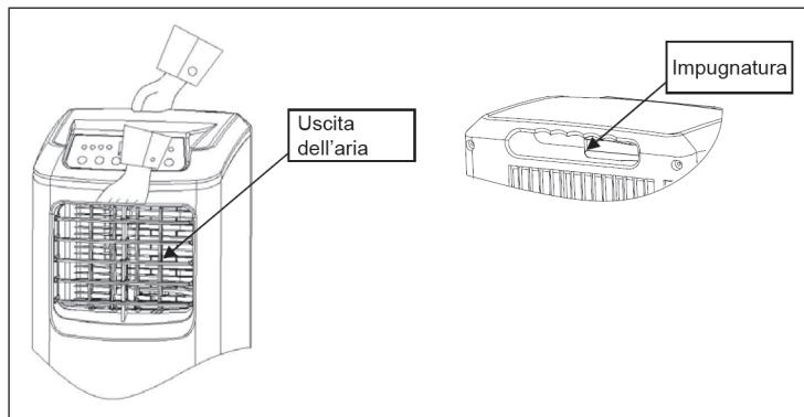
**Nota:** Non sollevare il dispositivo tramite i deflettori orizzontali e non inclinarlo durante il trasporto. Se il telecomando è nel suo alloggiamento, toglierlo prima di sollevare il dispositivo.
