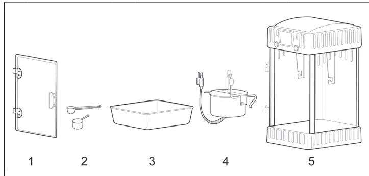
1 Tür                    3 Entnehmbare Schale                    5 Gehäuse
